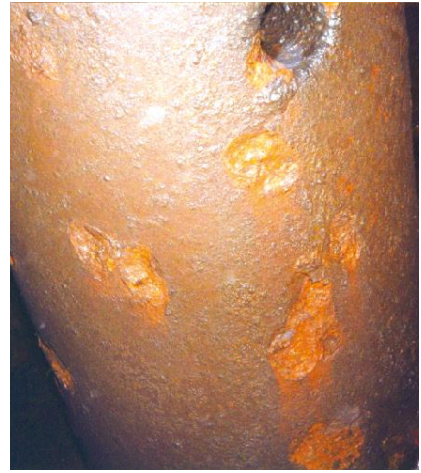
氧腐蚀造成的SUNROD™ 针型管的损伤（点蚀）
